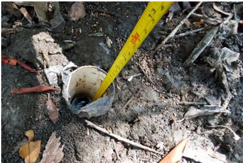
Figura 9. Medición de la profundidad a la que se encuentra el nivel freático.
