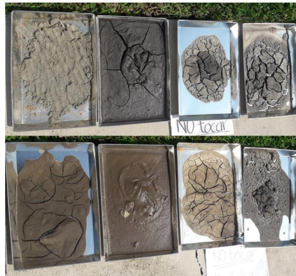
Figura 4. Secado de las muestras de sedimentos a temperatura ambiente.
