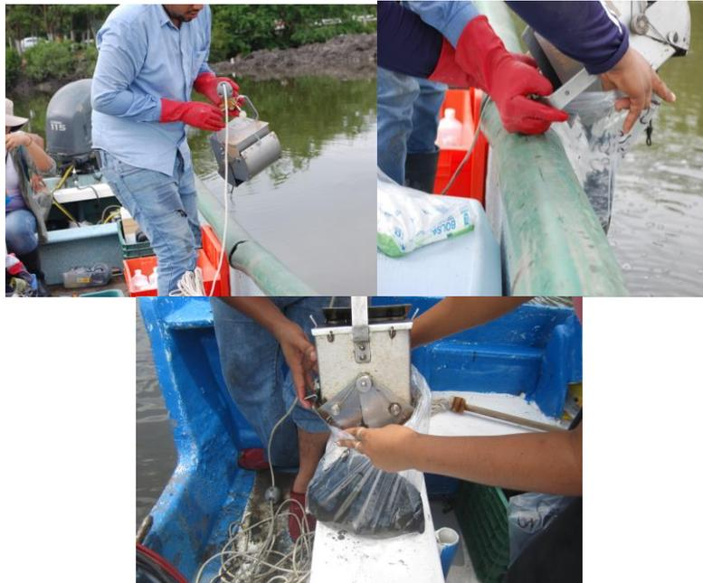
**Figura 4. Colecta de sedimento y trabajos con la draga en la laguna del Valle de las Garzas.**
