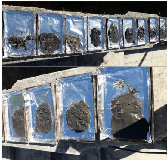
**Figura 5. Secado de las muestras de sedimentos a temperatura ambiente.**
