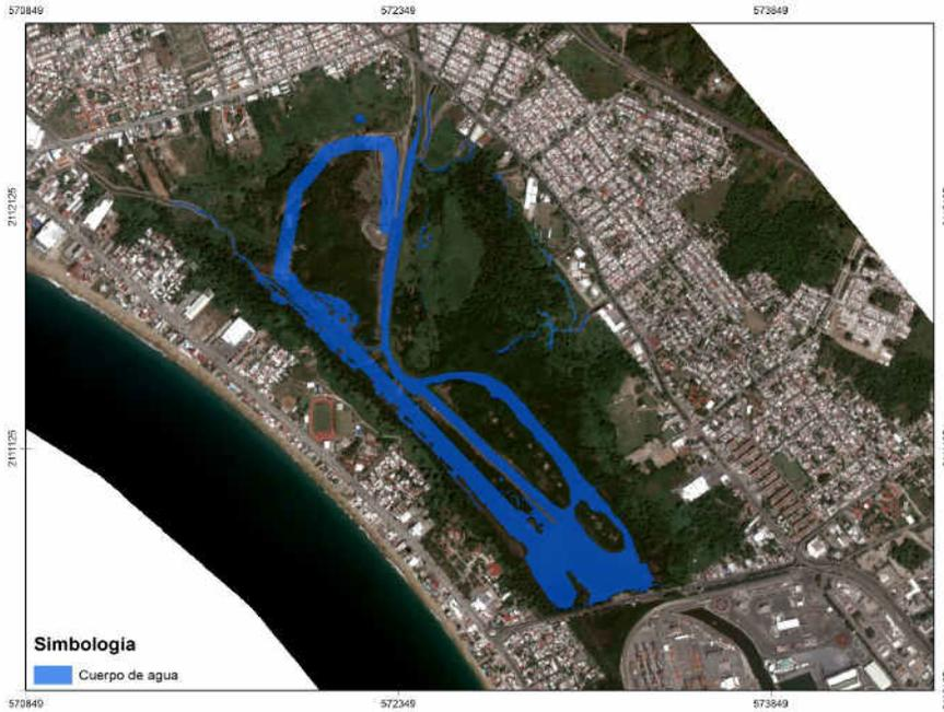
Figura 186. Cuerpo de agua implementado en DELFT 3D: a) caso 1 y b) caso 2, ambos con profundidades constantes de 2 metros.
