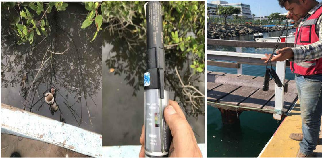
**Figura 21. Instalación del Hobo (H1a y H2) en la Laguna del Valle de las Garzas y en el muelle de API.**
