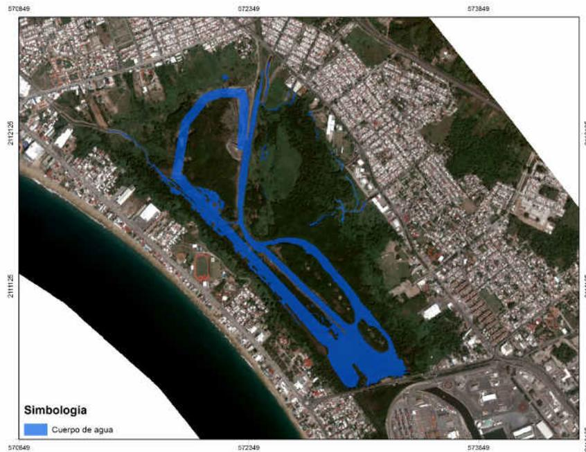
**Figura 196.** Cuerpo de agua implementado en DELFT 3D con profundidad constante de 2 metros.
