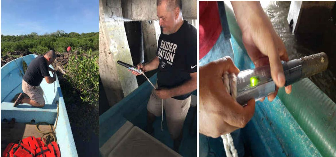
**Figura 19. Instalación del Hobo (H1a y H2) en la Laguna del Valle de las Garzas y abajo del puente de la carretera Manzanillo-Cihuatlán.**
