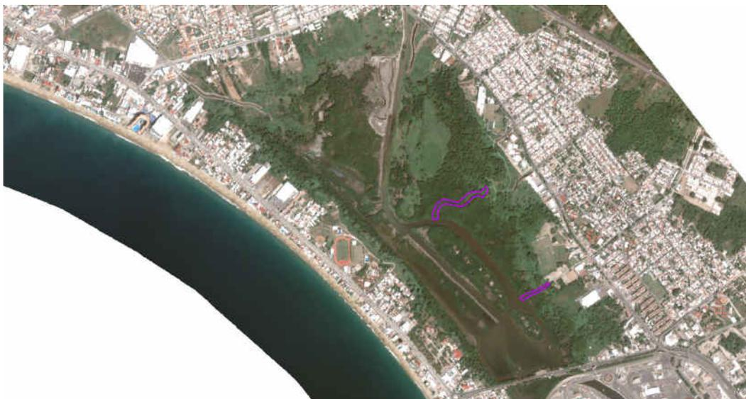
**Figura 197.** Canales auxiliares con profundidades constantes de 2 metros, anexados al Caso 2.
