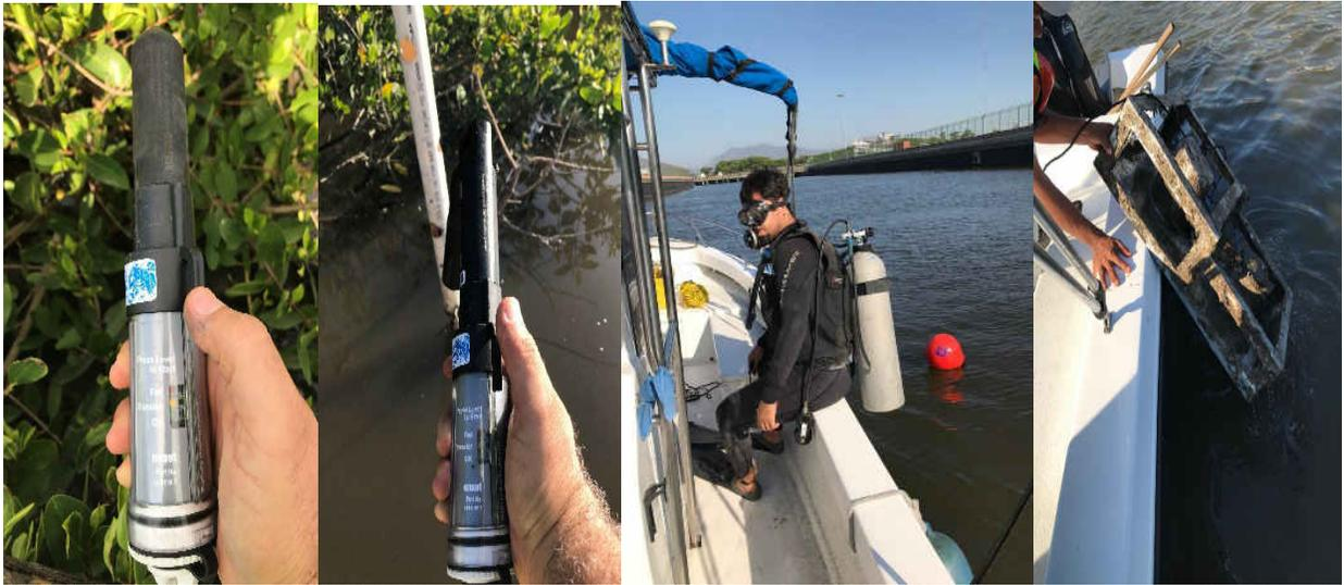
**Figura 23. Instalación del ADP1 y colecta de datos del Hobo (H1a y H2) en la Laguna del Valle de las Garzas y en el Canal de comunicación laguna-puerto Interior.**
