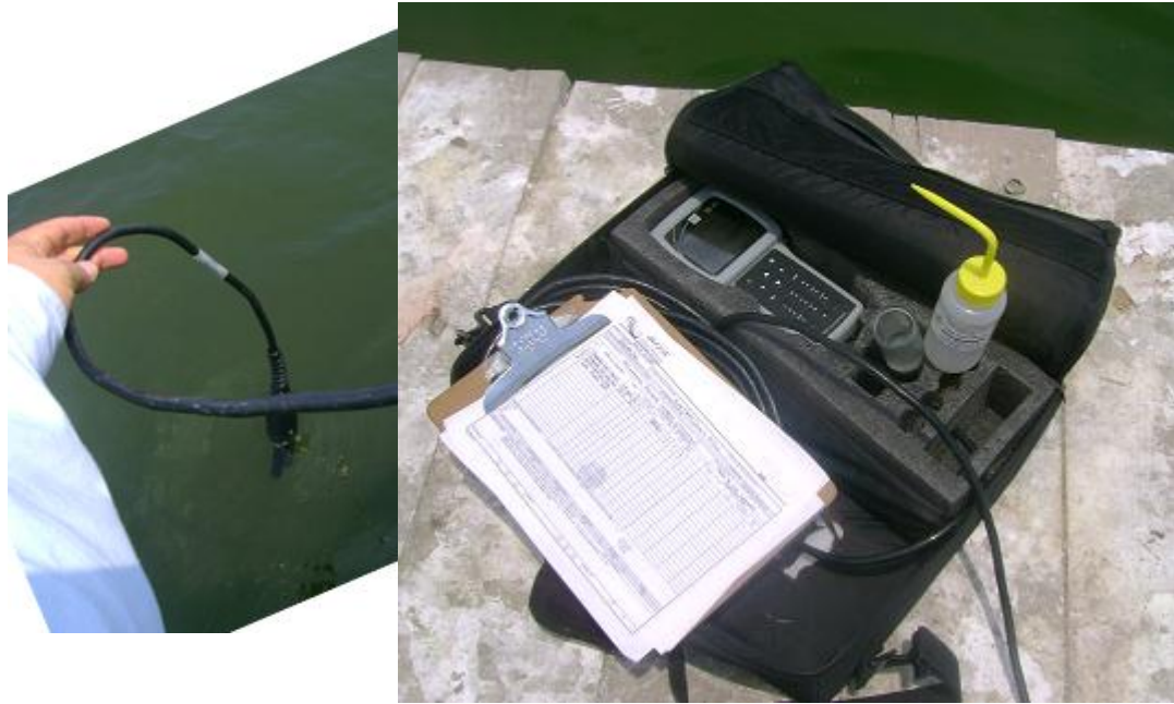
Figura 3. Equipo multiparámetro usado en las determinaciones de parámetros de campo en agua de sistema lagunar.
