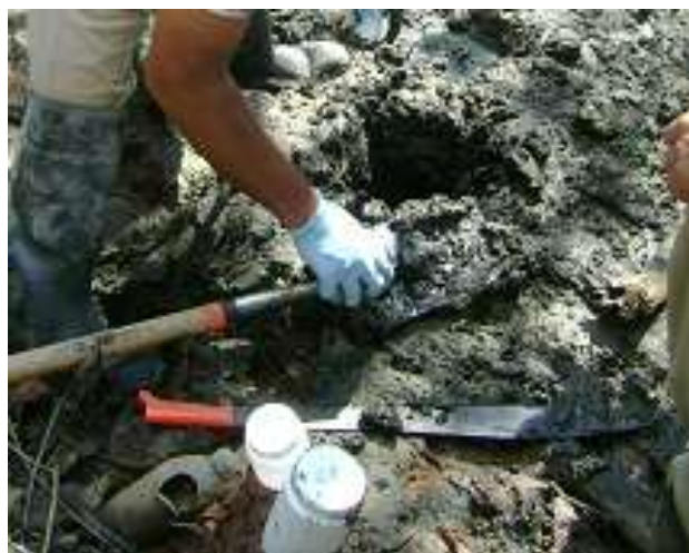
Figura 4. Excavación en uno de los 10 puntos de monitoreo para toma de muestra y análisis de parámetros de campo en suelo y agua intersticial.
