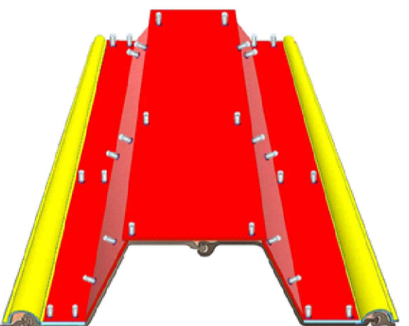
Se colocan placas de poliéster de alta densidad perforadas y cortadas sobre medida como protección mecánica.
