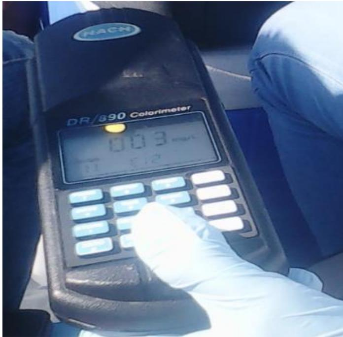
Figura 13. Equipo HACH para la medición de cloro residual.
